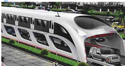
Ônibus se move por dois trilhos, cada um em uma faixa da pista, e permite que os carros trafeguem por baixo.
