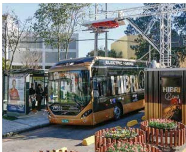
carga de bateria em pontos de embarque e desembarque de passageiros, levando, no máximo, 6 minutos para efetuar uma carga total.
